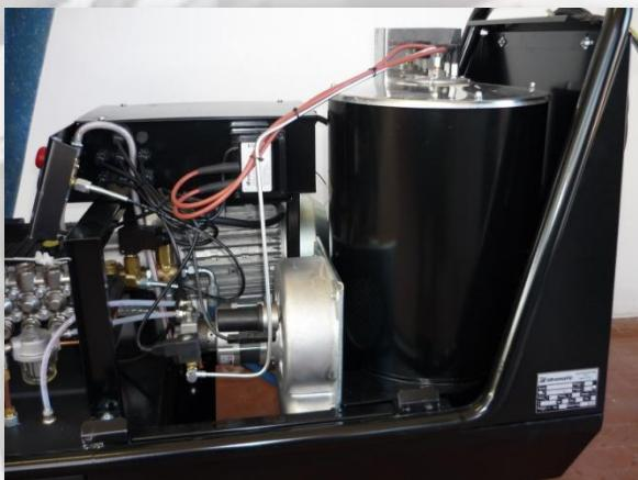
**Caldaia di produzione ad alto rendimento, con serpentina ad ampio diametro ed elevato spessore.**
