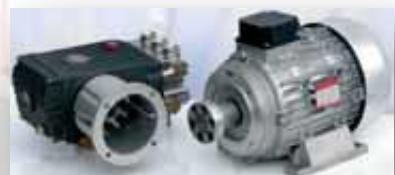
**Pompa a 3 pistoni in ceramica, sistema biella/manovella con testata in ottone. Accoppiamento elastico motore-pompa tramite giunto. Motore 1400 giri servizio continuo con protezione termica.**
