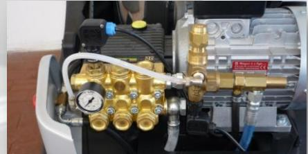
**Pompa a 3 pistoni in ceramica, con testata in ottone. Accoppiamento elastico motore pompa tramite giunto. motore elettrico, servizio continuo, a 2 o 4 poli con protezione termica.**
